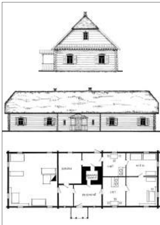
Tipiško dvigalio gyvenamojo namo su kaminu-virene priemenėje planas ir fasadai Ažytėnų k. Kėdainių r. Gryčia ir priemenė perdalintos į keletą smulkesnių patalpų, seklyčios pusė išlikusi vientisa (LLBM)
